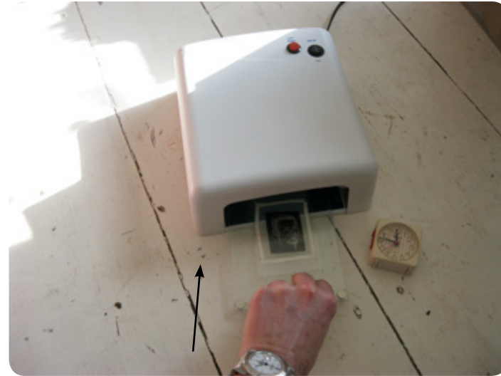
18 - replacer ensuite les deux plaques de verre et leur contenu à l'intérieur de la lampe UV. Contrôler que le typon se trouve bien au dessus de la feuille de polystère semi-opaque matte.
