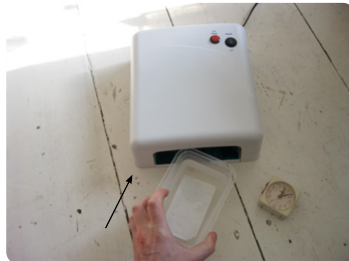
36 - glisser le tupperwear et son contenu précautionneusement à l'intérieur de la lampe UV, sans faire déborder l'eau.
