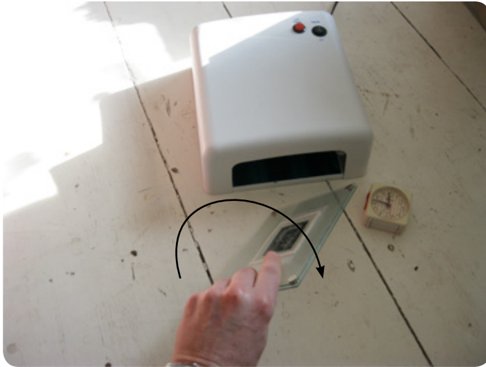
17 - retourner les deux plaques de verre et leur contenu, de façon à ce que le typon se trouve au dessus de la feuille de polystère semi-opaque matte.
