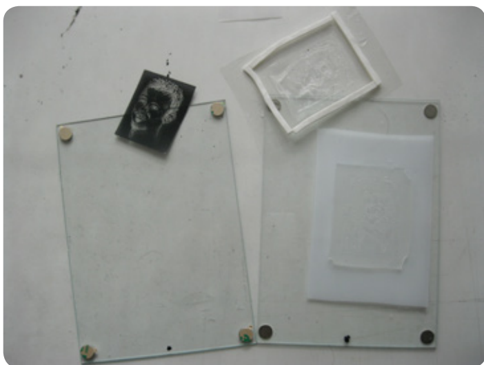
23 - La feuille de polyester transparente et ses bandes de joint est complètement décollée. Elle peut être réutilisée pour fabriquer d'autres tampons.
