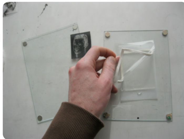
22 - enlever le typon, puis décoller doucement la feuille de polyester transparente du photopolymère durci aux UV. Le photopolymère durci doit resté coller à la feuille de polyester semi-opaque matte.
