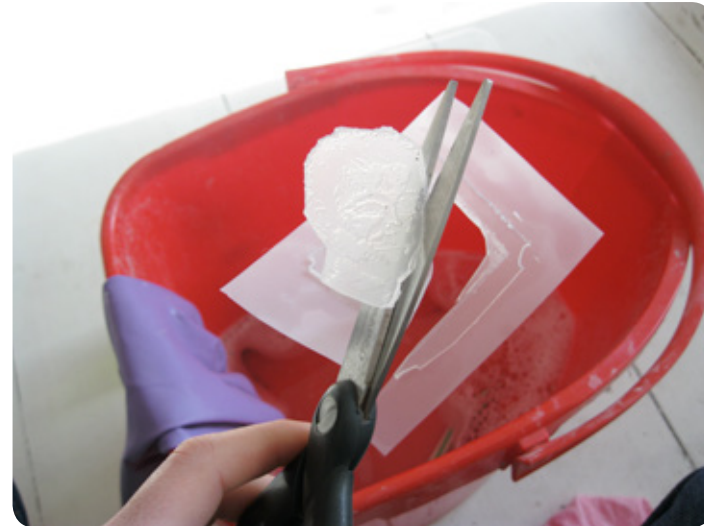
34 - découper les bords du tampon au plus près du motif, pour se débarrasser de la surface de photopolymère durci inutile.
